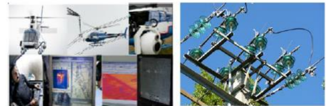
Contrôle des lignes par mission héliportée 2 opérateurs
